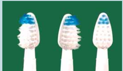
Abb. 4-6: Amplitude der Schallzahnbürste Waterpik Sonic Max. Ihre Borsten werden durch die Schwingungen von ca. 250 Hz aus der Nulllage heraus nach jeder Seite ca. 4 mm weit ausgelenkt.
